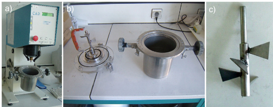
Fig. 4. a) Rheocad 400, b+c) stirrer(s) and b) bowl.
